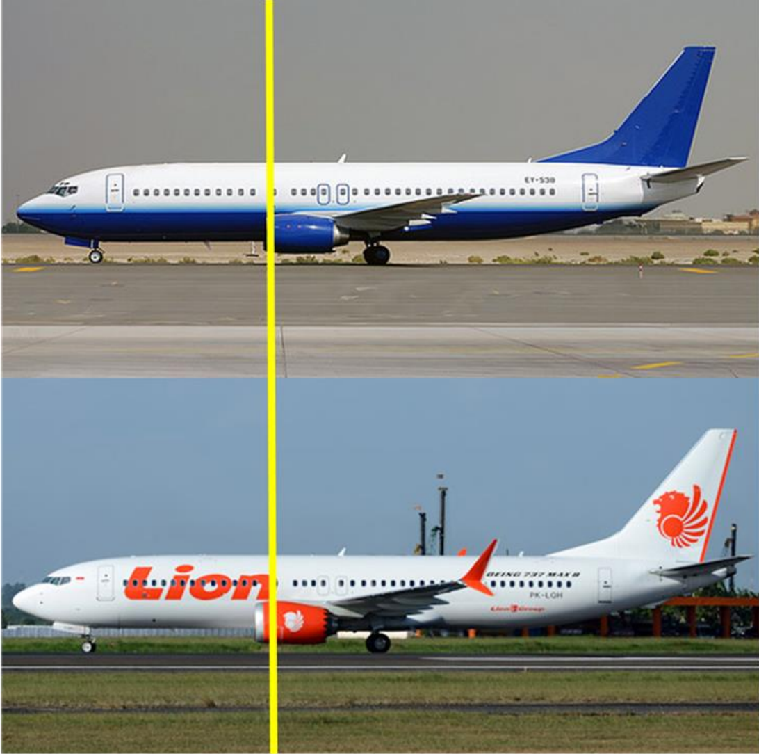
Üstte Boeing 737-400, altta ise düşen Boeing 737 MAX 8 modeli uçakların motorlarının yerleri. Kaynak: Airlines Inform
