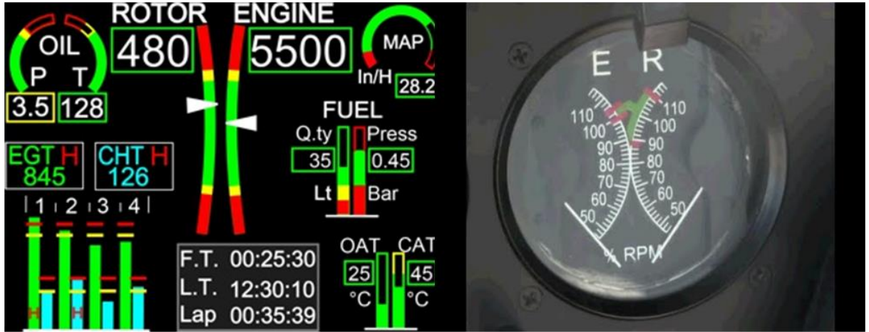
Solda sayısal ve sağda analog Motor/Rotor RPM Göstergesi ve çalışma sahaları
