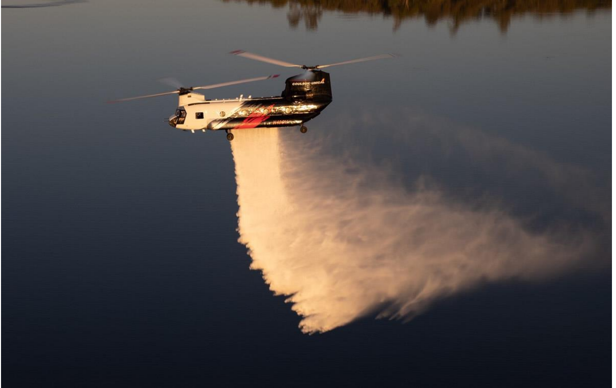
Gövde içi deposundan su/geciktirici ajan atımı yapan bir CH-47 helikopteri
