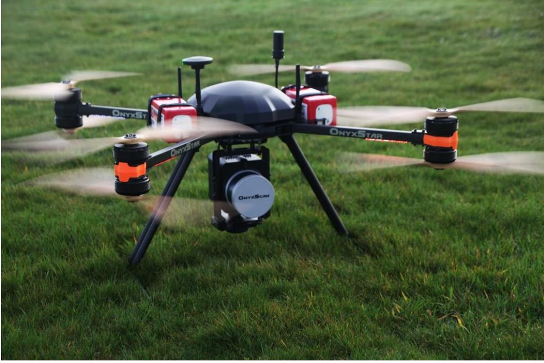
Dron üzerine takılmış OnyxScan LIDAR. Kaynak: AltiGator Solutions
